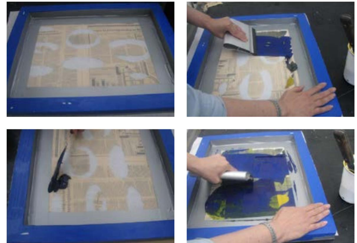
5. Colocando un rasero en ángulo de 45 grados sobre la malla, se presiona jalando con fuerza para distribuir y transferir la pasta de estampe a través de la malla del marco.
