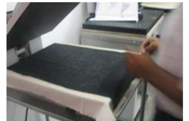
Hay que distribuir uniformemente el *thermo gel* sobre la tela. El adhesivo se aplica con fuerza, y para tener una buena aplicación de la goma hay que dar tres pasadas con el rasero.
